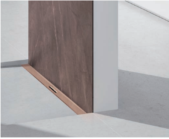
Viega Advantix Cleviva. Innowacyjne rozwiązanie łączące zalety odpływu liniowego i punktowego. Woda odprowadzana jest tutaj wąskim profilem ze stali szlachetnej do centralnego odpływu punktowego. Produkt dostępny w kilku modnych obecnie kolorach, takich jak np. złota miedź szczotkowana. VIEGA, www.viega.pl
